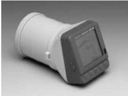
図8 電離箱サーベイメータ
