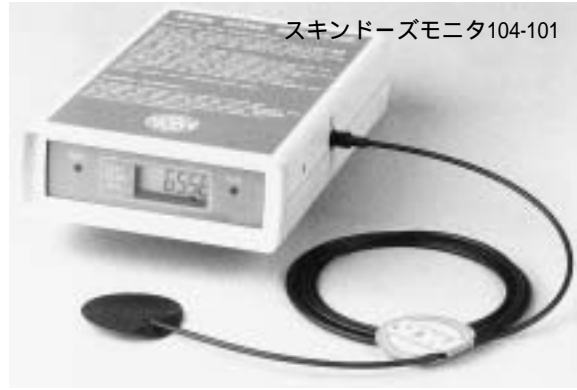
図6 SDM線量計 スキントーズモニタ (SDM) は、シンチレータとフォトダイオードを用いたリアルタイム読み取りの吸収線量計である。センサは、無機シンチレータ (ZnCd) の微小円盤型の結晶で、サイズは1mm 2 × 0.25mm (公称) である。シンチレータの部分からは、1.5mのプラスチックファイバでSDMまで光信号を導く。この光信号を、SDMリーダー内に取り付けられたPINフォトダイオード正面パネルに吸収線量 (mGy) として表示する。
