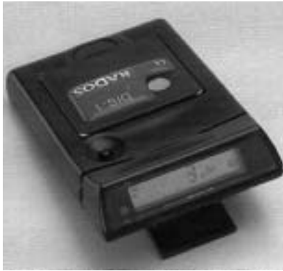
図5 DIS-100ポケット線量計 DIS線量計は、電離箱とMOSFETで構成された電子線量計で、1cm線量当量、70 μm線量当量が表示される。PCとの接続のためのPCR-1アダプタを使用してシステムに組み込み、トレンドデータを得ることが可能である。
