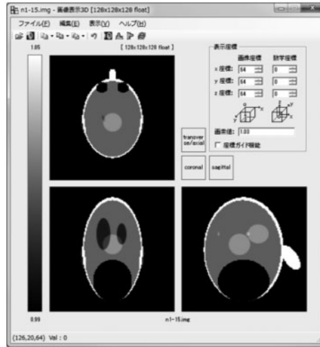
図 7-5 プログラム「P1-15shepp3d_divide.c」で作成した 128 \times 128 \times 128 画素の 3 次元 Shepp-Logan ファントム
