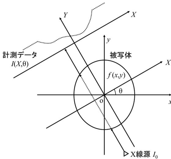
図 1-6 座標系を含めたX線CTの計測の様子
