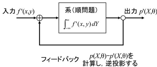
図 1-12 フィードバックの考えによる X 線 CT における繰り返しの方法
