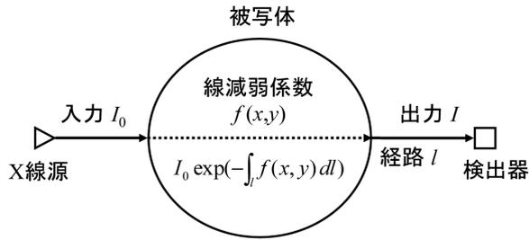
図 1-5 X線源からX線を被写体に照射し反対側の検出器でX線の強度を検出する様子
