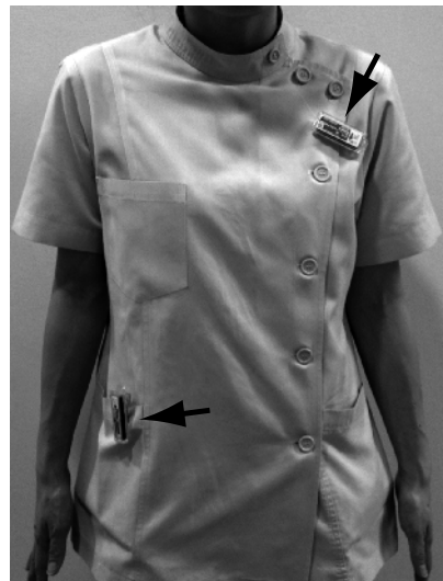
図 2-3 線量計を付ける位置 (←: 線量計)
