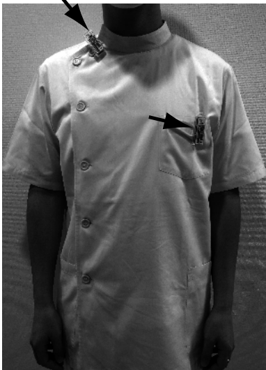
図 2-3 線量計を付ける位置 (←: 線量計)
