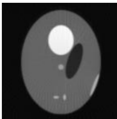
図 4-8 Sorenson の前補正法で補正した図 4-7 に示した投影データから再構成した画像 輪郭の長さ T は投影データから算出している .
