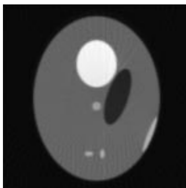
図 4-6 Sorenson の前補正法で補正した図 4-4 に示した投影データから再構成した画像 輪郭の長さ T は楕円データから算出している .
